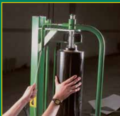
Sichern der neuen Rolle
