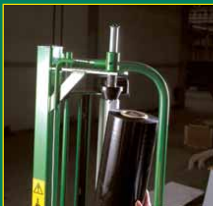
Chargement d'un nouveau rouleau
