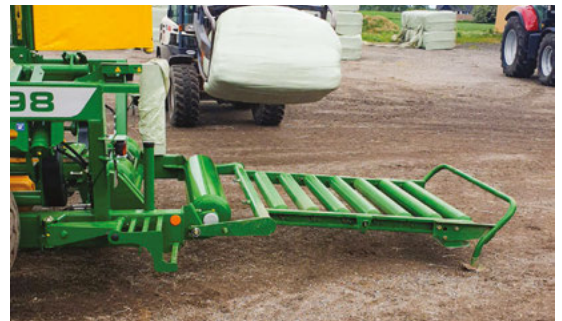
Convoyeur statique d'enrubannage et de déchargement
