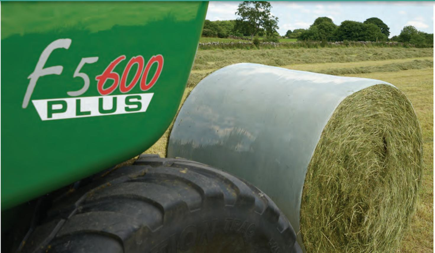
La technologie du « film sur film » permet d'appliquer plusieurs couches de film de liage dans la chambre de pressage, en lieu et place du filet traditionnellement utilisé pour maintenir la balle. Le film de liage permet d'avoir plus de couches de film sur la partie ronde de la balle (partie la plus fragile).
