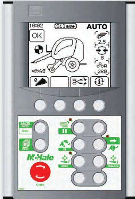
La F5600 est contrôlée avec un boîtier de contrôle Expert Plus, qui dispose d'un large écran graphique permettant à l'opérateur de surveiller le processus de pressage à partir du boîtier de commande. Il dispose également :
