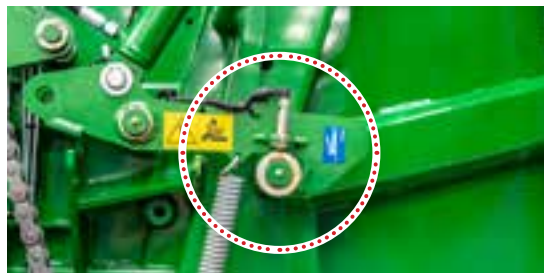
Mechaniczne zatraski komory
