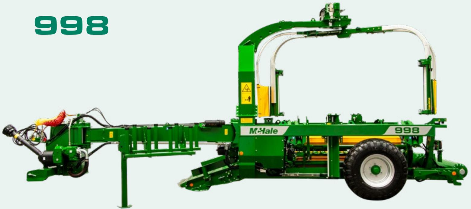
**DER 998 QUADERBALLENWICKLER** ist eine leistungsstarke Maschine mit zahlreichen Funktionen, darunter ein voll integriertes, zapfwellenbetriebenes Load-Sensing-Hydrauliksystem, Förderbandbeladung mit Schnellpositionierung der Quaderballen in Wickelposition, hydraulisches Schneid- & Haltesystem, automatische Quaderballennivellierung und in Unterkeranhängung montierter Schwenkkopf.
