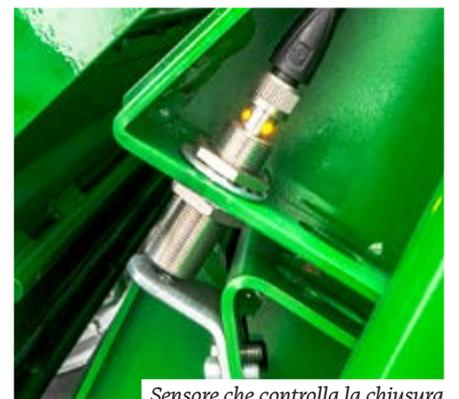
Sensore che controlla la chiusura del canale di alimentazione
