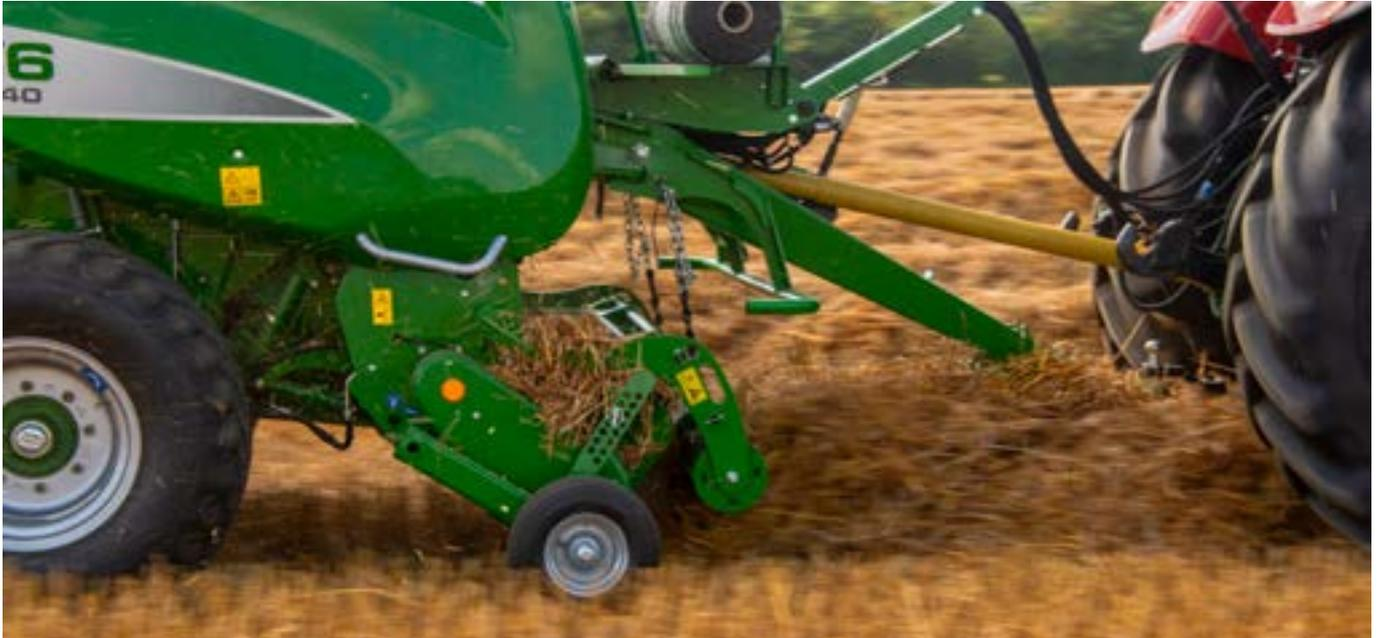
Der neue, konisch zulaufende Zuführkanal verbessert den Erntegutfluss von der Pick-Up zum Rotor und in die Ballenkammer, wodurch der Durchsatz maximiert wird. McHale hat ebenfalls die seitlichen Förderschnecken nach vorne versetzt und ihre Enden zum Rotor hin abgewinkelt.
