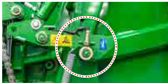
Mechaniczne zatraski komory
